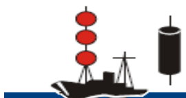
Restrita Devido ao seu Calado Regra 28
